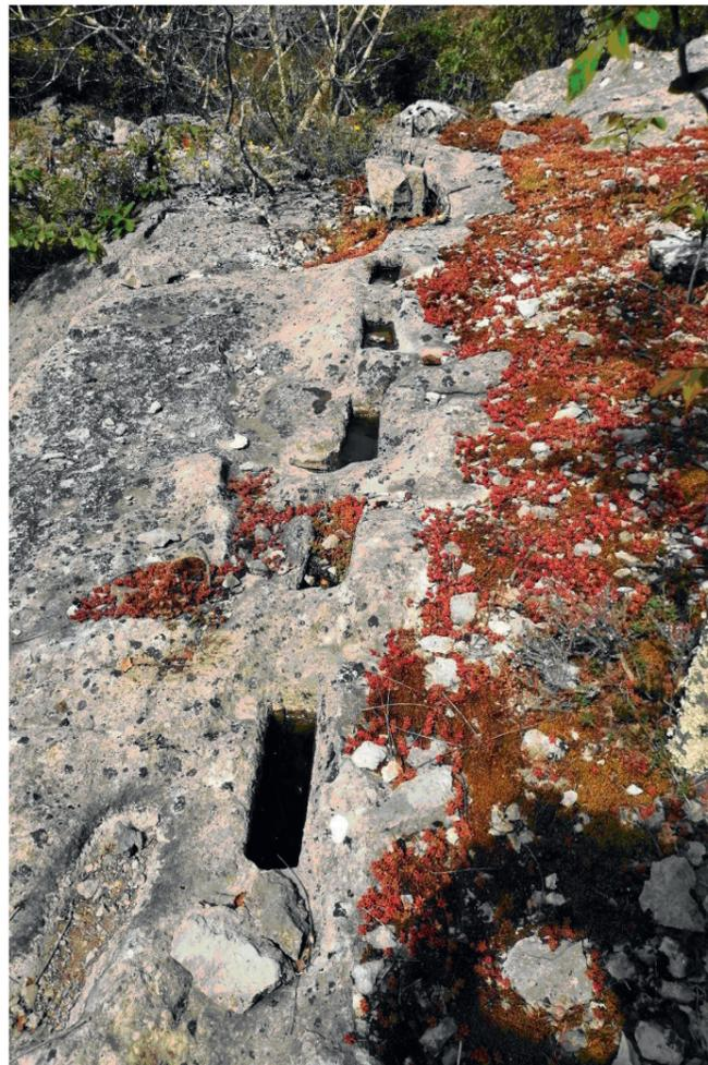
Ligne d'emboîtes préparant l'extraction d'un bloc
